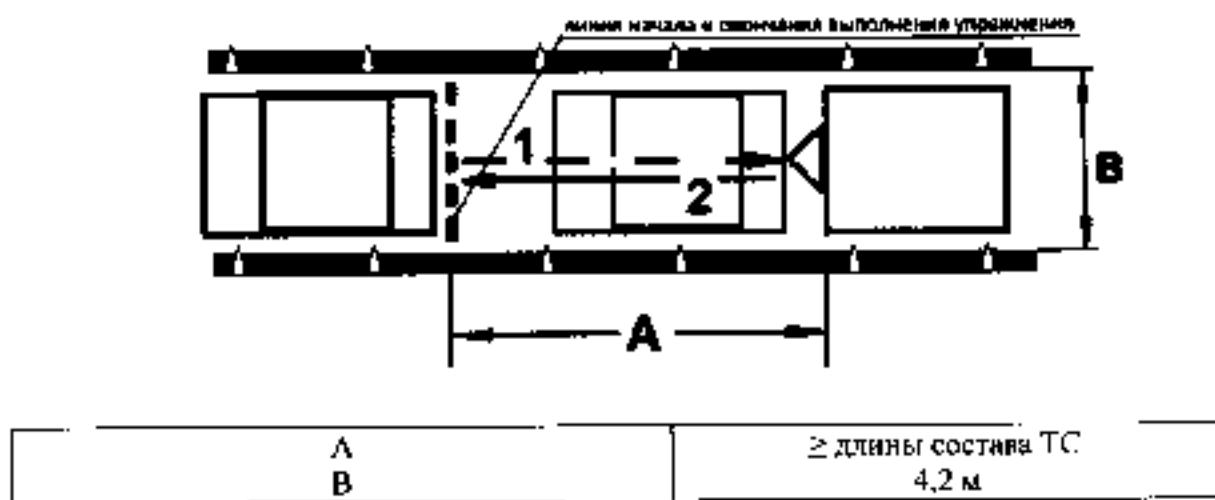
Рисунок 14. Схема и размеры элемента упражнения № 9 - «Сцепление прицепа с тягачом»
