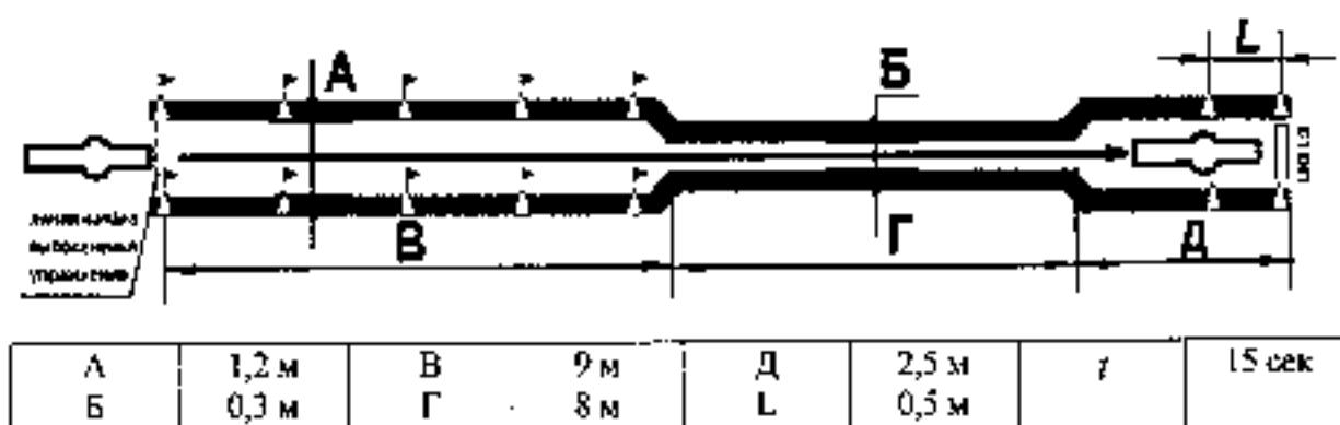
Рисунок 4. Схема и размеры элемента упражнения № 1 - «Габаритный коридор»
