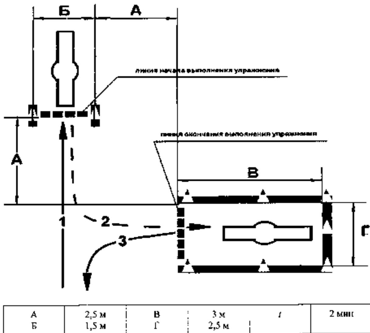
Рисунок 5. Схема и размеры упражнения № 2
