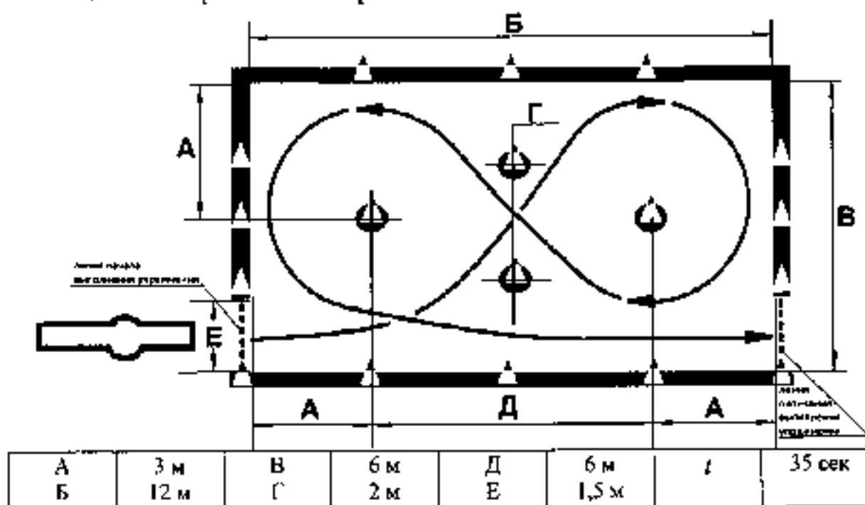
Рисунок 1. Схема и размеры элемента упражнения № 1 - «Габаритная восьмерка»
